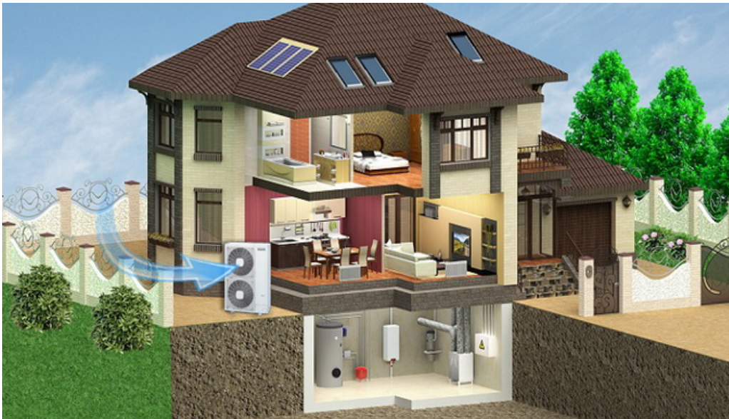
Նկ. 2. Օդային ջերմային պոմպի (օդ-ջուր) համակարգի տեղաբաշխման սխեման
